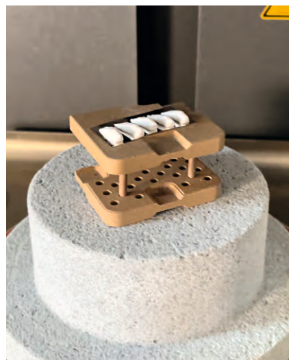
► ... auf Platinfolie fertig zum Brennen. Die Erhöhung sorgt dafür, dass die Brennproben eine ähnliche Position in der Brennkammer einnehmen, wie sie sonst unsere Krönchen haben.
